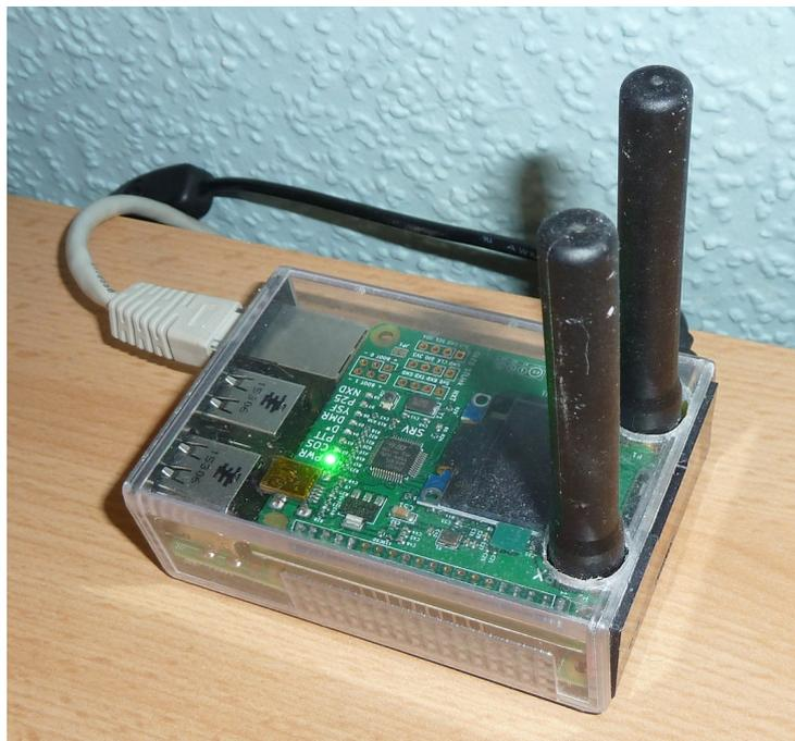
MMDVM Platine auf GPIO-Port eine Raspberry 2B montiert
